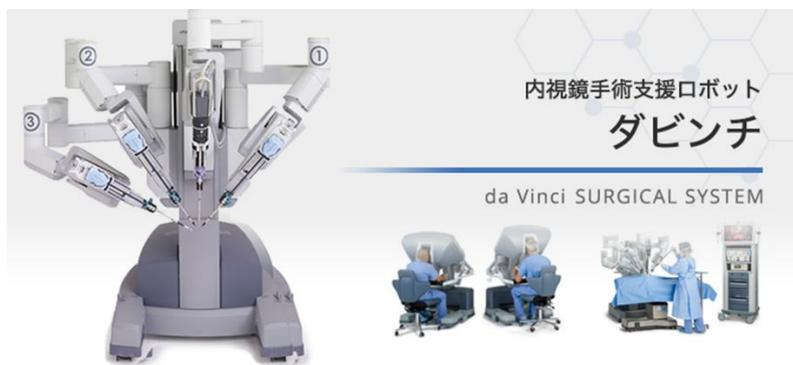
ロボット支援手術のメリットは手ブレ防止機能つきの高精度3Dカメラによる鮮明な画像、人間の手よりも可動域の広い多関節機能鉗子による優れた操作性などが挙げられます。カメラの操作は術者自身がコンソールに座って行いますので、術者の負担軽減と助手の役割減少の両面で働き方改革に繋がる可能性があります。
